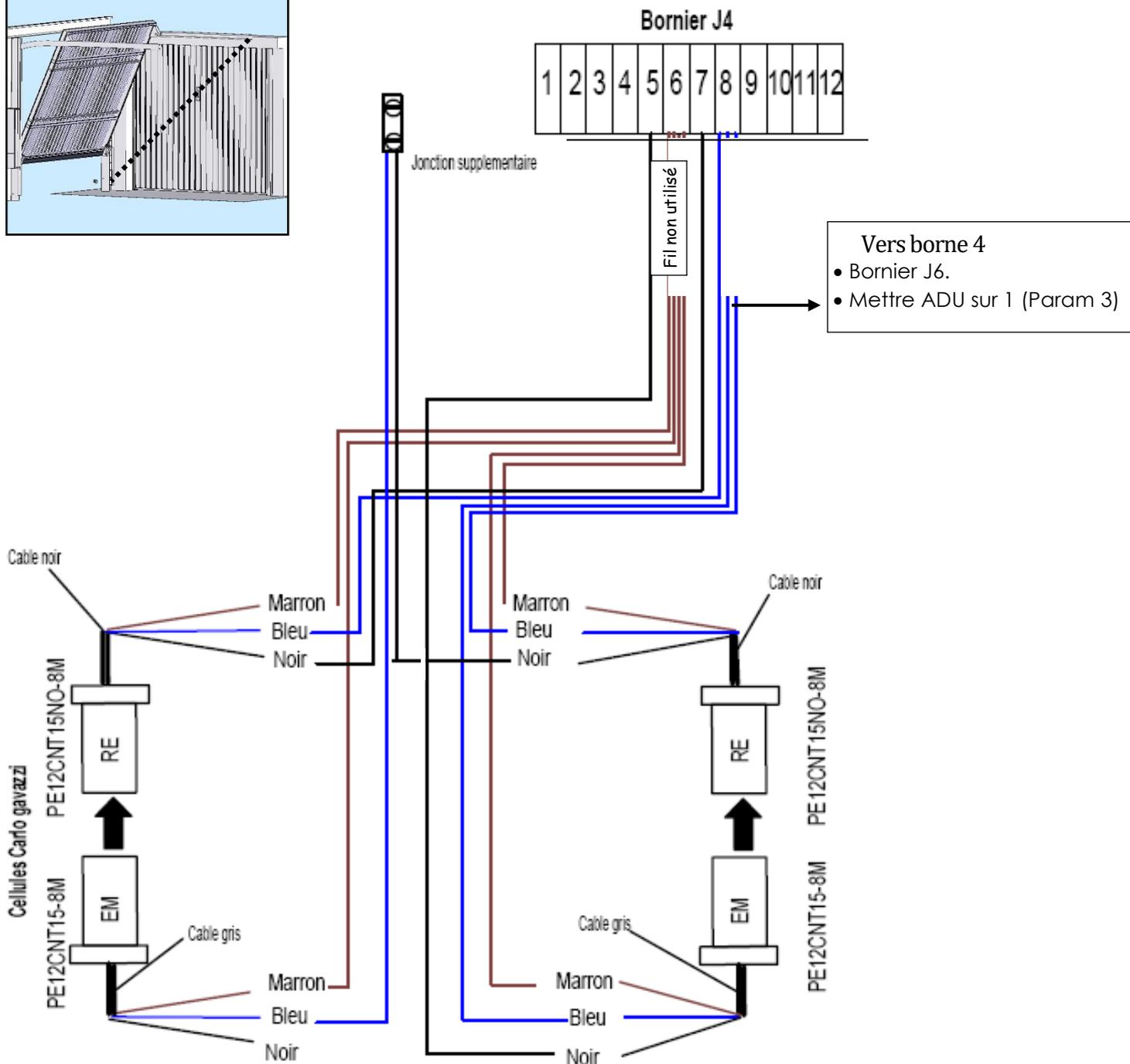
Câblage des cellules de protection poutre arrière ou protection sous linteau.
